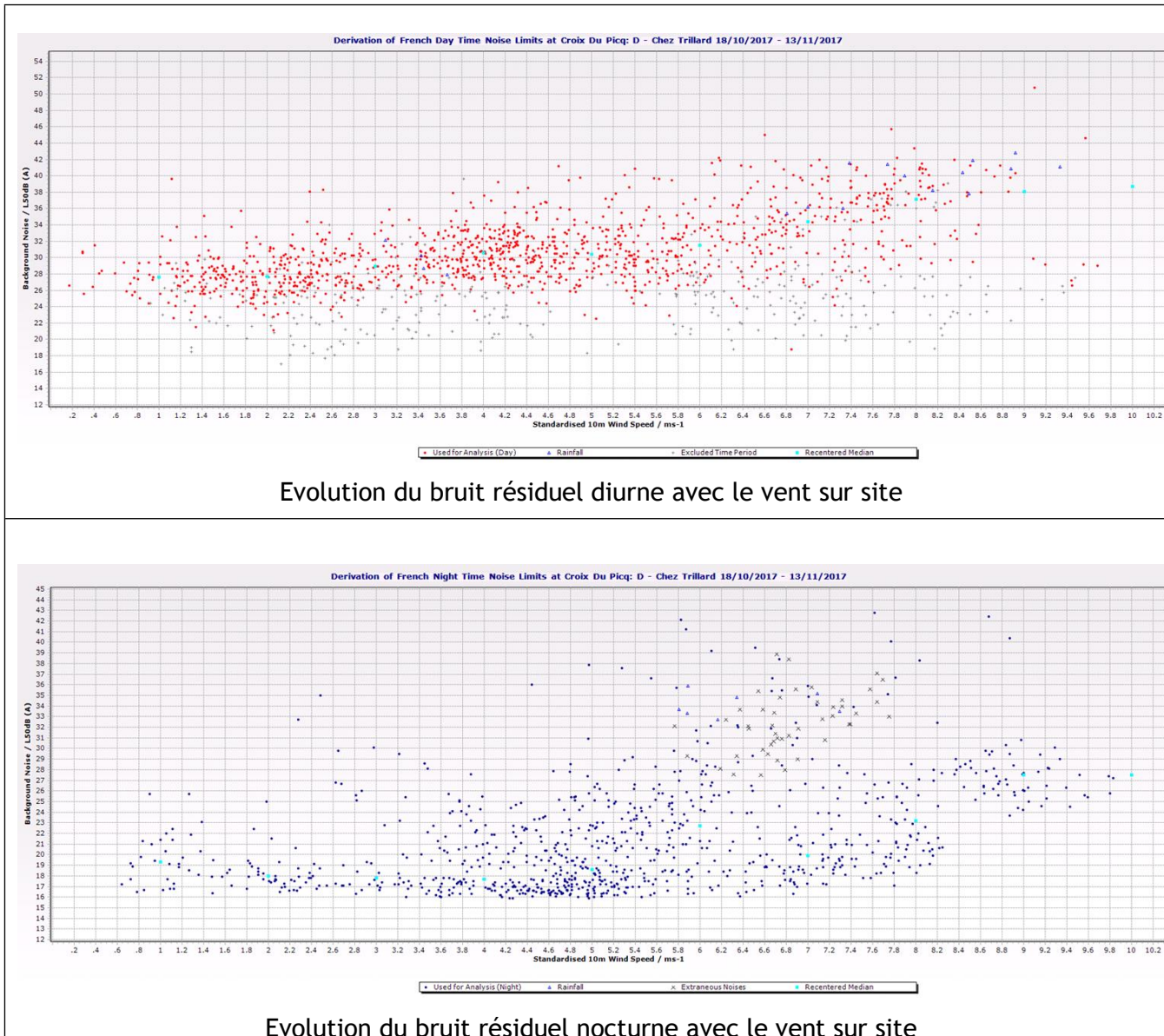
Figure 27 : Evolution du niveau sonore résiduel en fonction de la vitesse du vent sur site, sur les périodes cœur de journée (7h-19h) et diurne (22h-7h) pour la ZER Chez Trillard (Point de mesure D)
